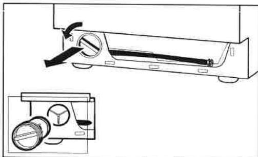
5. Enlevez corps étrangers et dépôts de peluches. Nettoyez l'intérieur de la pompe. Les ailettes de celle-ci doivent pouvoir tourner.
