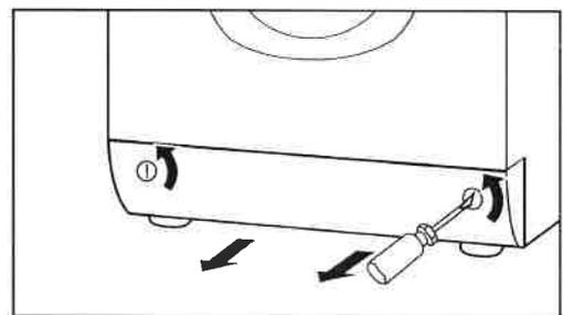
2. Faites sortir le tuyau de vidange, retirez-en le bouchon de fermeture, laissez l'eau s'écouler dans le panneau du socle. Répétez l'opération plusieurs fois si nécessaire.
